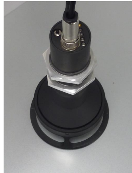
Offline-Aufsatz für Labormessungen
